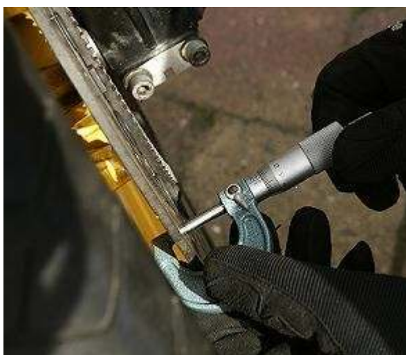
Foto boven: controle van een remschijf (dikte)
